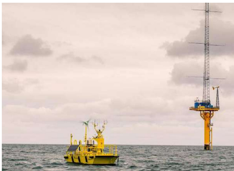
Figura 21 – Instalação LIDAR flutuante (Fonte: Windpower Engineering & Development).
