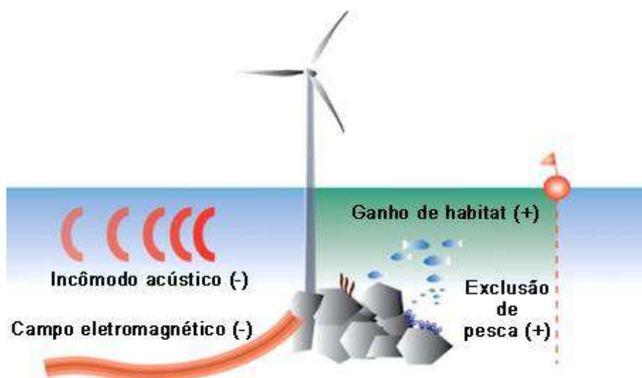
Figura 48 – Principais questões ambientais associadas à presença física dos aerogeradores offshore (adaptado de Bergström et al. , 2014).
