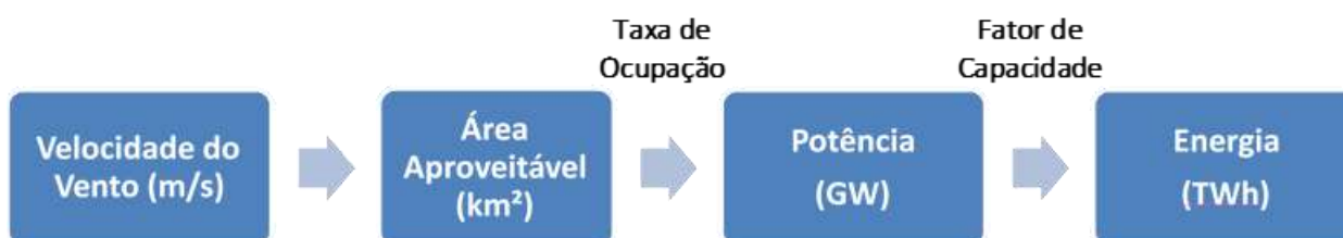
Figura 3 – Metodologia utilizada para estimativa do potencial eólico offshore .
